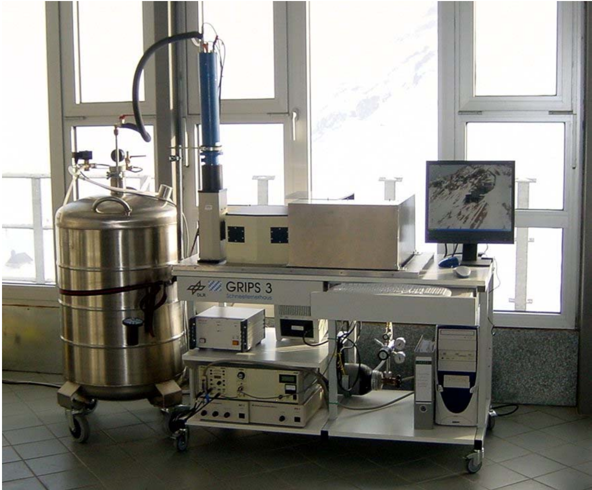
Abb. A.2.1: Das GRIPS 3 Instrument in der Umweltforschungsstation Schneefernerhaus (UFS) zur operativen und automatischen Erfassung der OH*-Temperatur in der Mesopausenregion.
