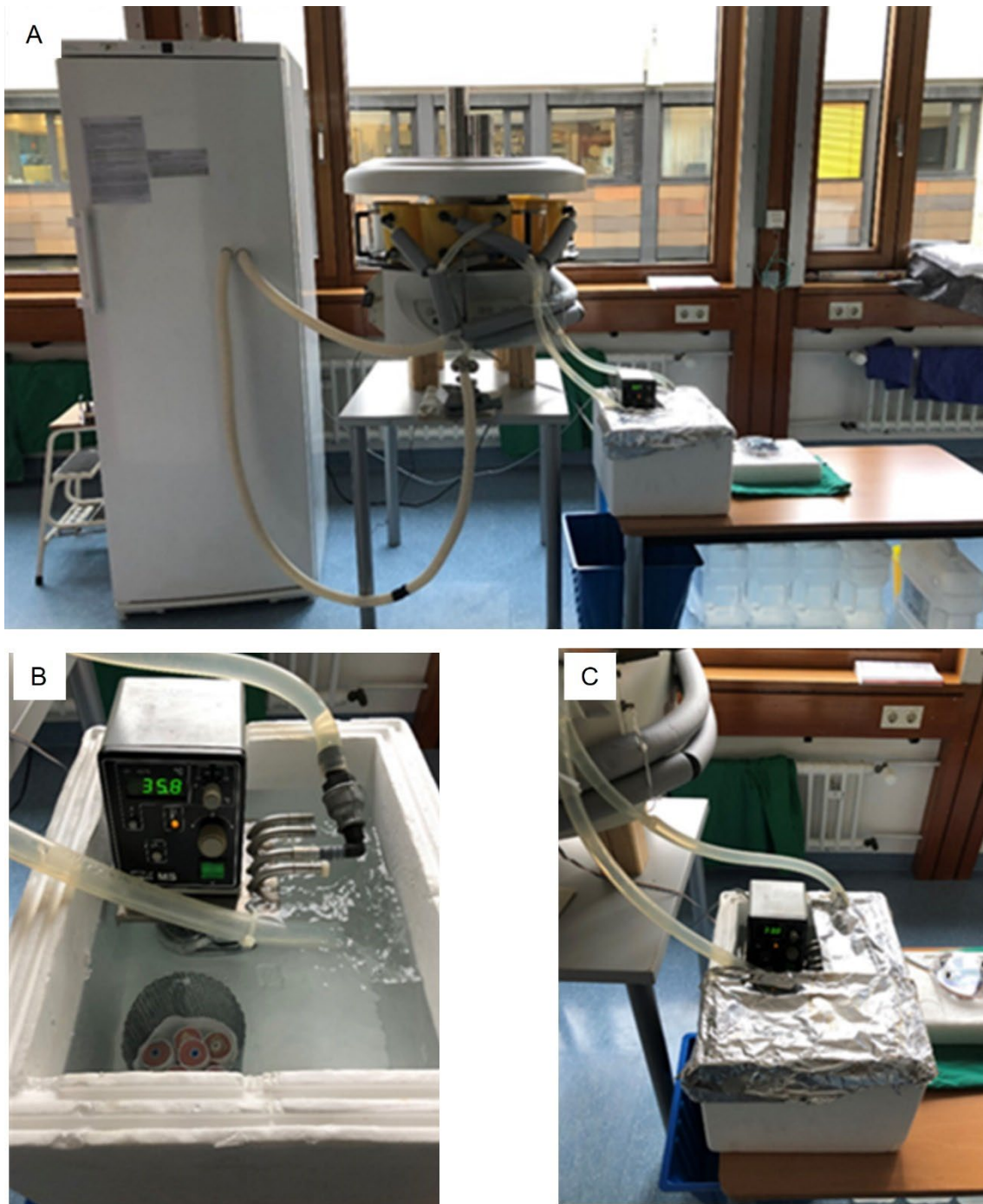
Abbildung 21: TC im Aufbau. (A) in der Übersicht: V.l.n.r.: Kühlschrank, Parafin-Einbettungsgerät (Fa. Leica, Wetzlar) und Wasserbad (B, C) .
