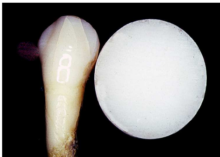
Abb. 5: Künstlicher schmelzähnlicher Hydroxylapatit als Probenkörper für standardisierte Untersuchungen über De- und Remineralisation von Zahnschmelz. Der Probenkörper ist nicht nur äußerlich mit dem Zahnschmelz vergleichbar, sondern auch in seinen wesentlichen physikalischen und chemischen Eigenschaften [53].
