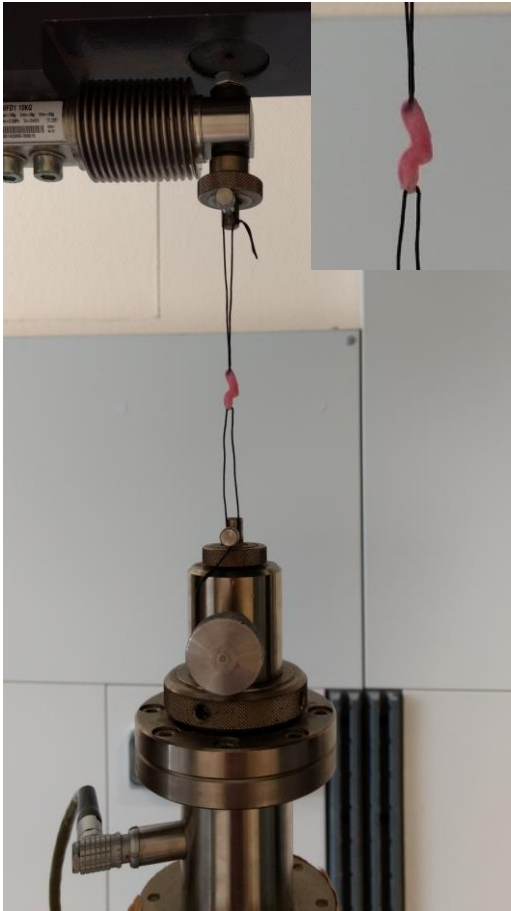
ABBILDUNG 6: VERSUCHSAUFBAU DER BIOMECHANISCHEN MESSUNG AN DER ZWICK
