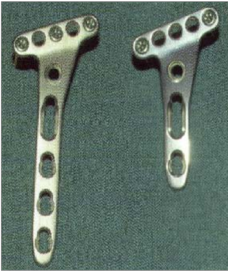
Abbildung 22: winkelstabiles distales Radiussystem 2,4 mm mit 2,4 mm Kopfverriegelungsschrauben distal und Kombinationslöchern für 2,4 mm Kopfverriegelungsschrauben oder 2,4 mm bzw. 2,7 mm Kortikalschrauben im Schaft (Firma Synthes®) (Wagner et al.2004).
