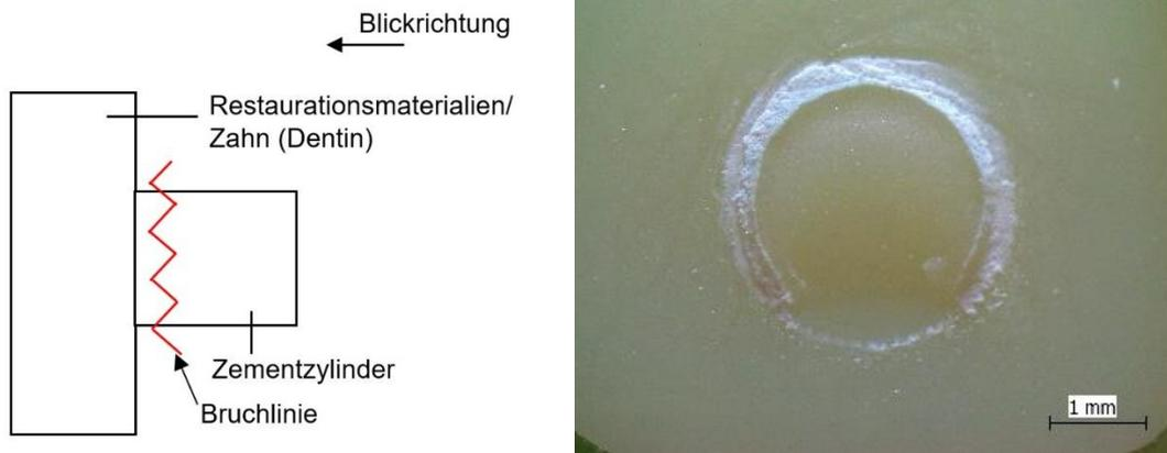
Abbildung 15: Kohäsiver Bruch im Befestigungszement, (eigene Abbildung)
