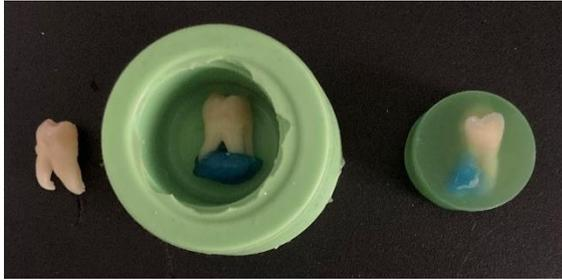
Abbildung 5: Herstellung der Probenkörper mit extrahierten 3. Molaren (eigene Darstellung)
