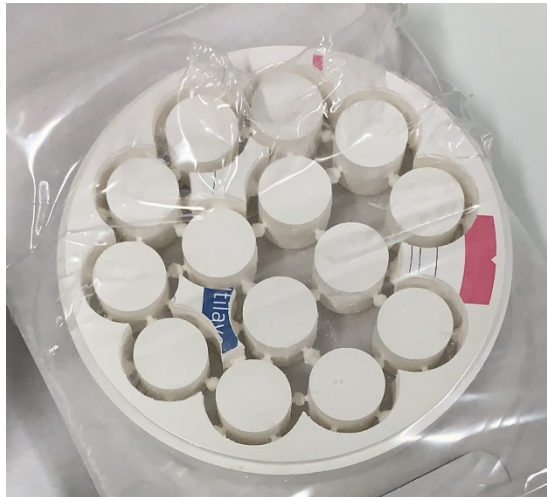
Abbildung 7: Multilayer-Disk nach dem Fräsen
