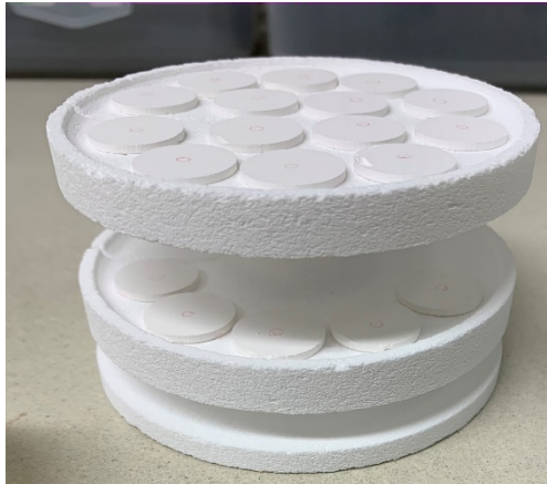
Abbildung 9: Proben auf dem Träger vor dem Sintern
