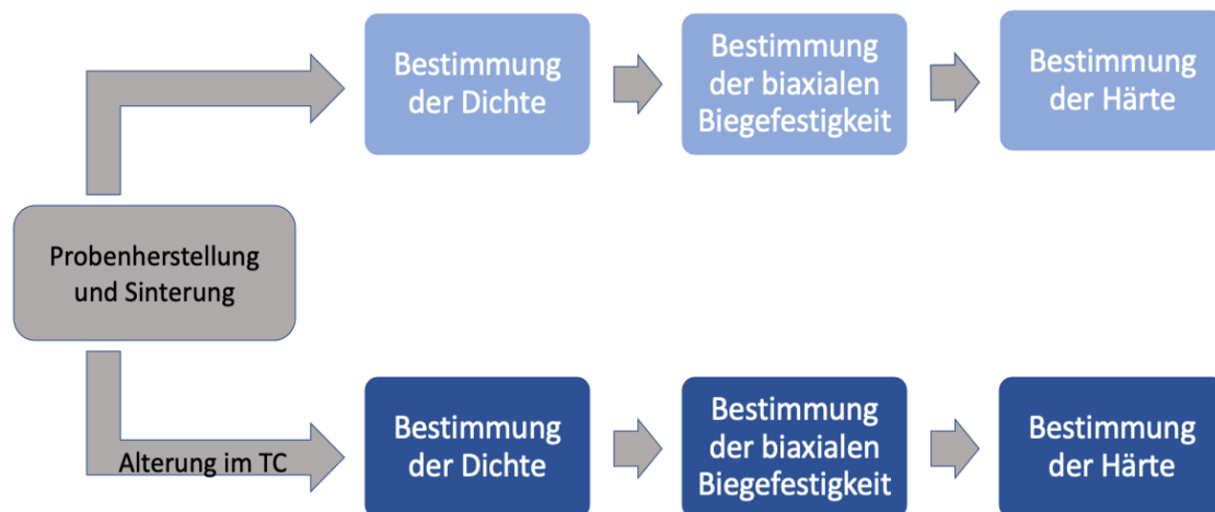
Abbildung 13: Schematischer Ablauf der Versuche
