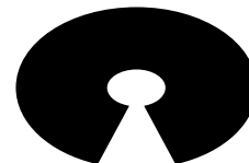
Abbildung 1: Querschnitt einer kaum per CNC-Technik zu konstruierenden Kugel mit innerem Hohlraum
