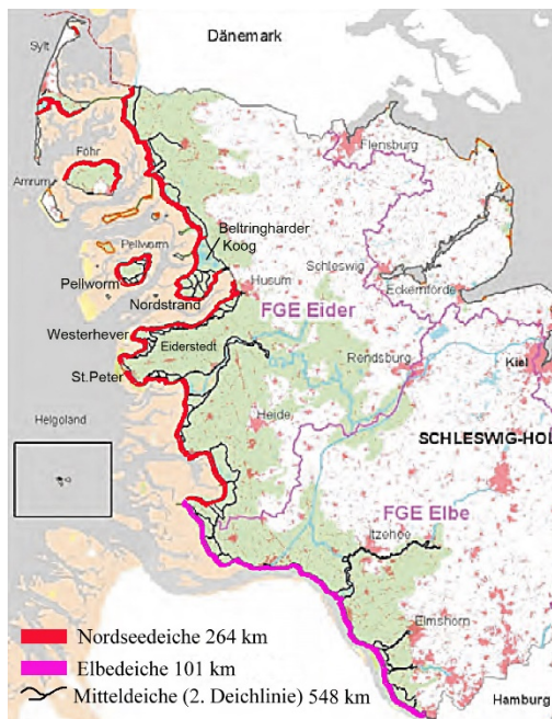
Abb. 1 Landesschutzdeiche der Nordseeküste (rot) und Elbe (violett), die in den nächsten Jahrzehnten erhöht (verstärkt) werden sollen. Auch ein Teil der Mitteldeiche (schwarz) soll ertüchtigt werden. Aus MLUR (2013), verändert Fig. 1 Land protection dikes of the North Sea coast (red) and River Elbe (purple), which are to be raised (strengthened) in the coming decades. Some of the middle dikes (black) will also to be upgraded. From MLUR (2013), modified
