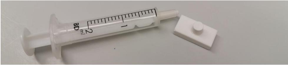
Abbildung 4: Applikationsmöglichkeit der zementbasierten Kleber mit Hilfe einer Spritze.
