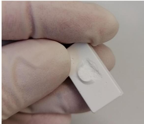
*Abbildung 14: Beispiel eines Prüfkörperversagens in Form eines Ausrisses, der durch Sekundenkleber verursacht wurde.*
