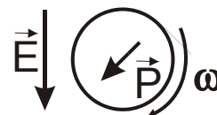
Abbildung 97: Durch die Rotation wird die Polarisationsachse gegenüber dem E-Feld verschoben
