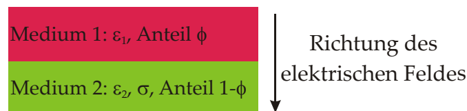
Abbildung 21: Eine Schichtstruktur, bestehend aus einer isolierenden und einer leitenden Schicht mit unterschiedlichen frequenzunabhängigen Permittivitäten' [Kre03] führt dennoch zu einer frequenzabhängigen Relaxation
