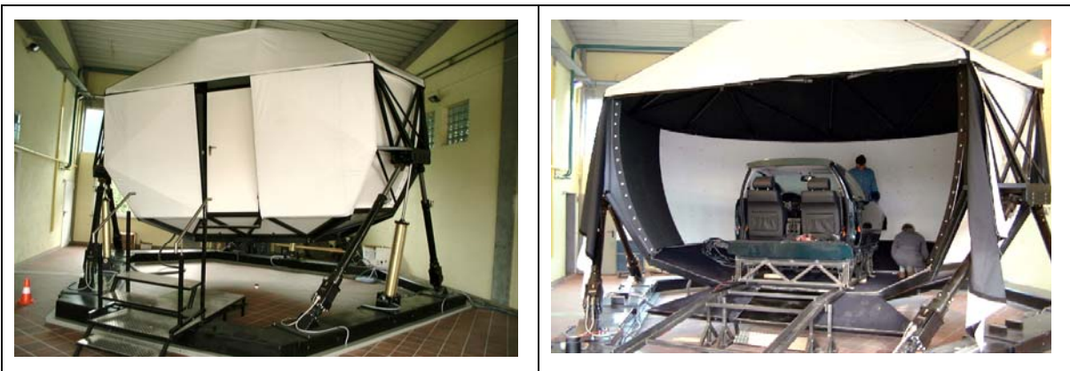
Abbildung 6-1: Der Würzburger Fahrsimulator in Betrieb (links) und während des Aufbaus (rechts). In der Kuppel zu sehen sind die Fahrzeugkonsole (BMW 520i) und die Projektionsfläche für die Frontsicht.
