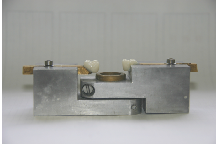
Abbildung 5: Apparatur zur Simulation der Nachbarzahnsituation
