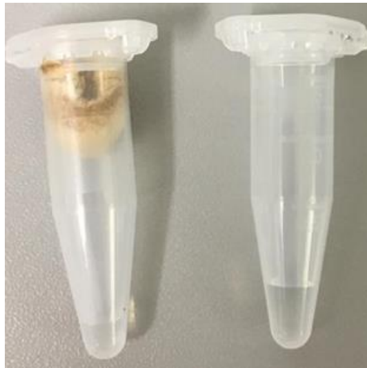
d) links: Eppendorfgefäß nach Zentrifugation mit Filterpapier, rechts: Eppendorfgefäß mit asservierter Schweißprobe
