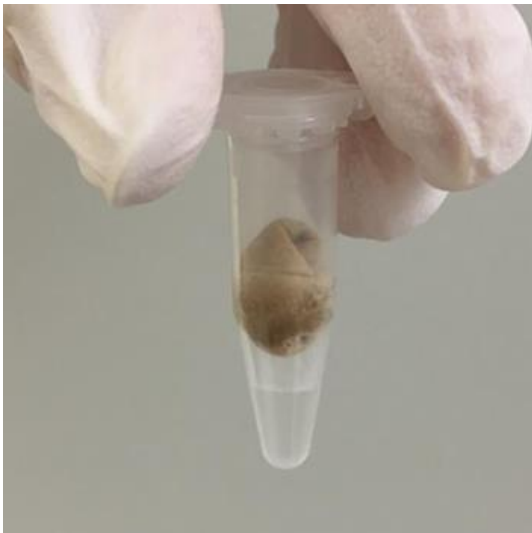
c) Situation nach dem Zentrifugieren. Im unteren Teil hat sich die Schweißprobe gesammelt.
