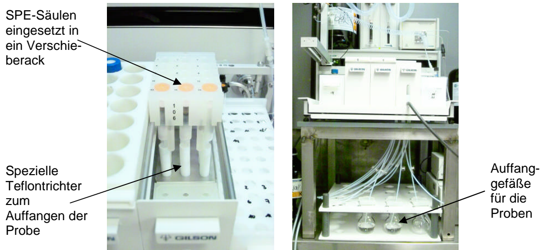
Abbildung 11: ASPEC XLi-System, umgebaut für automatisierte SPE (Florisil- und Kieselgelsäulen).
