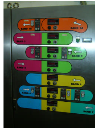
Abbildung 34: Steuerungseinheit des 7-Band-Trockners, die es ermöglicht, Temperaturen für jedes einzelne Band festzulegen
