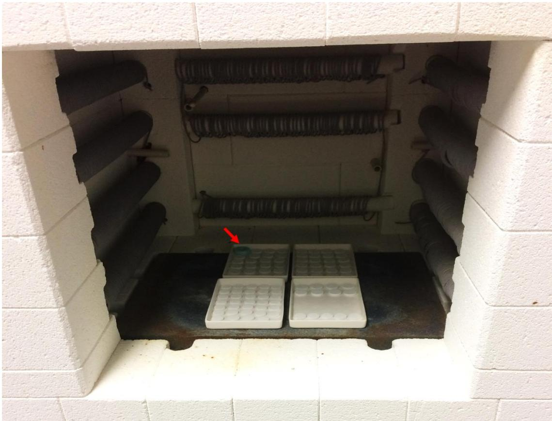
**Abbildung 4:** Sinterofen mit Scaffolds.
