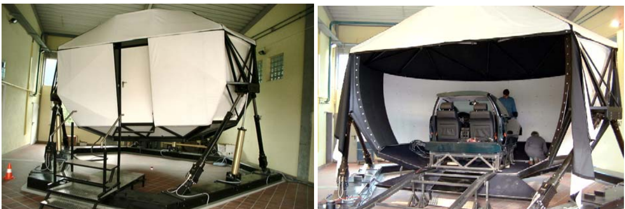
Abbildung 6-1: Der Würzburger Fahrsimulator in Betrieb (links) und während des Aufbaus (rechts). In der Kuppel zu sehen sind die Fahrzeugkonsole (BMW 520i) und die Projektionsfläche für die Frontsicht.
