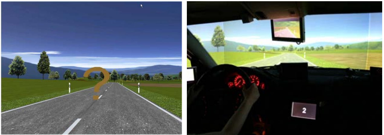
Abbildung 6-7: Angebot einer Nebenaufgabe mittels „?“ im Head-Up (links); Darbietung der Nebenaufgabe auf einem Display in der Mittelkonsole (rechts).
