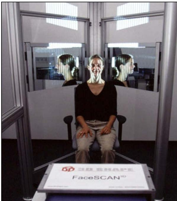
Abbildung 2: Spiegelkonstruktion für die Messaufnahme von Ohr zu Ohr.
