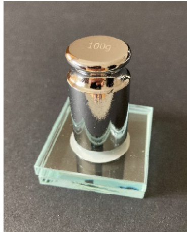
Abbildung 4: Anordnung des Versuchsaufbaus zur Prüfung der Fließfähigkeit. Das 100 g Gewicht ist auf den zwei 20 g Glasplatten mit dem dazwischenliegenden und komprimierten Material platziert.
