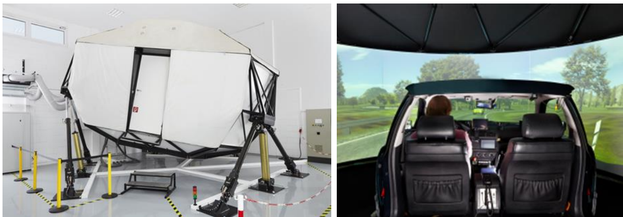
Abbildung 8. Der dynamische WIVW-Fahr-Simulator. Hexapod Bewegungssystem (links) und Simulator-Innenraum mit Fahrzeug-Mockup und Videoprojektion (rechts).
