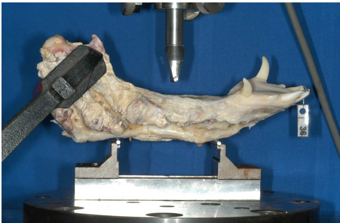
Abbildung 23: Versuchsaufbau Universalprüfmaschine Zwick
