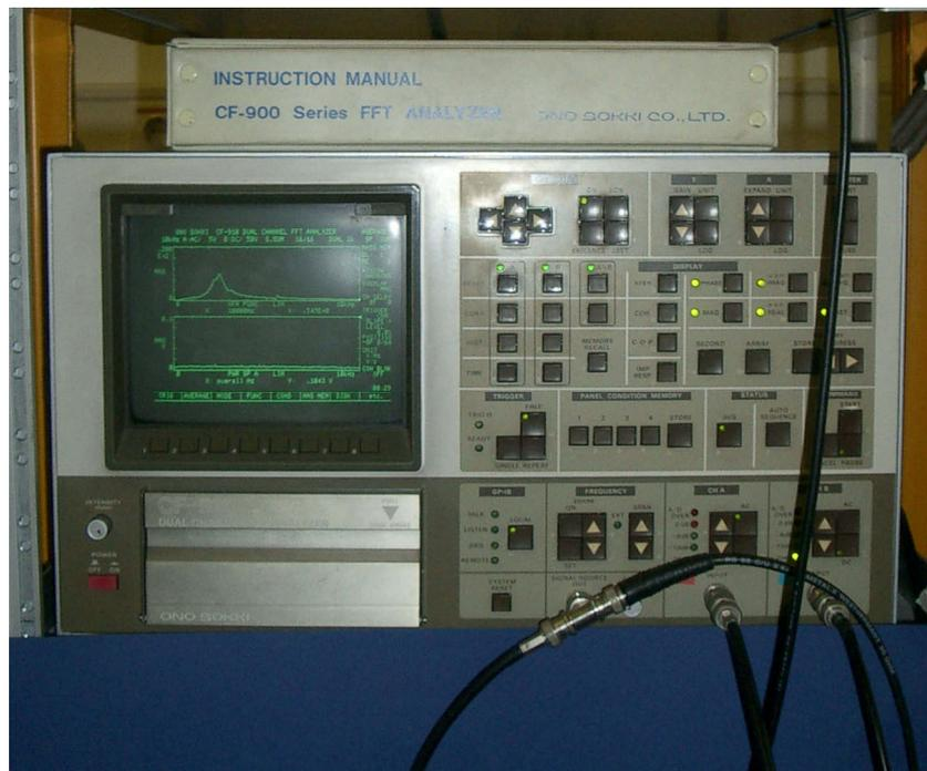
**Abb. 21:** FFT-Analysator der Firma Ono Sokki. Auf dem Display wird die aktuelle Übertragungsfunktion angezeigt.
