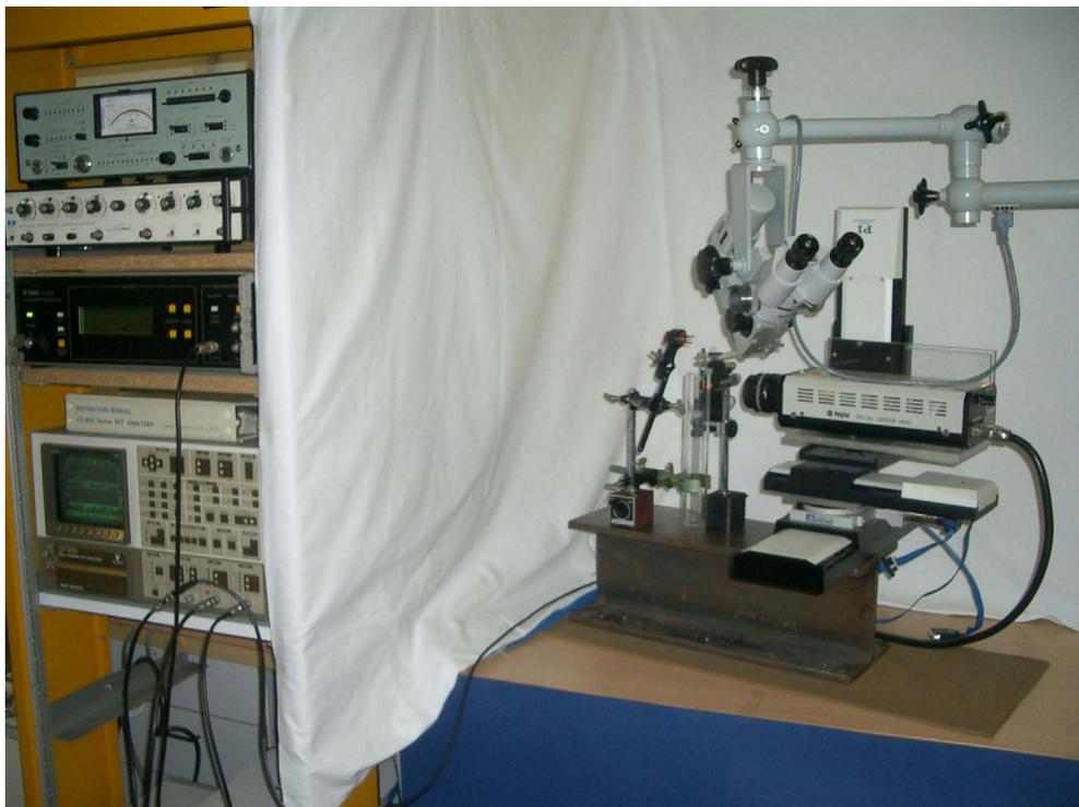
**Abb. 26:** Versuchsaufbau. Mit dem Mikroskop kann der Messpunkt festgelegt und der Scan überprüft werden. Der Steuer-PC ist nicht im Bild.
