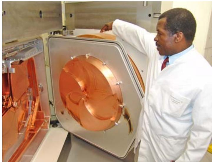
Die aufwändige Apparatur beschleunigt Protonen oder Deuteronen bis nahe an die Lichtgeschwindigkeit. Die rasenden Kernteilchen treffen auf Zielmaterialien und verwandeln sie in künstliche Radionuklide, also in instabile Atome, deren Kerne radioaktiv zerfallen.
