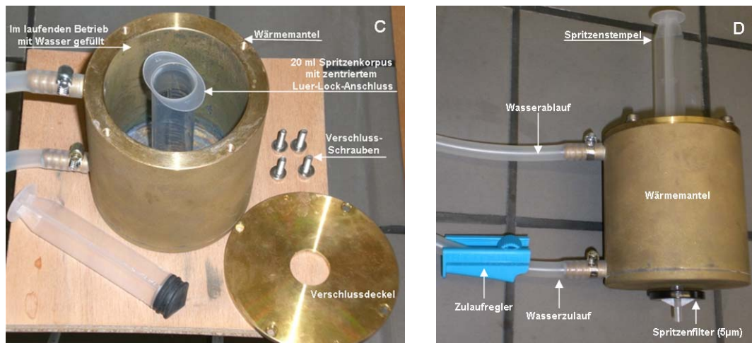
Abb. 4-1 Darstellung der Filtrationsapparatur (A, Übersicht; B, ausgebaute Spritze; C, Detailaufbau; D, Übersicht)
