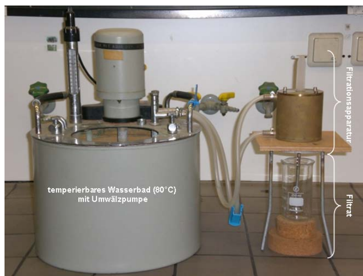
Abb. 3-24 Aufbau der Filtrationsapparatur (Details siehe Kapitel 4.7.2)
