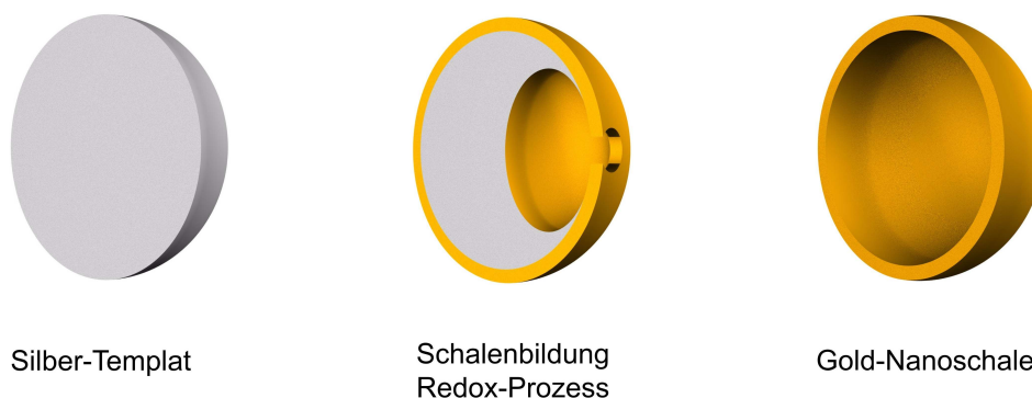
Abb. 45: Schematische Darstellung des Mechanismus der Gold/Silber-Nanoschalen-Bildung
