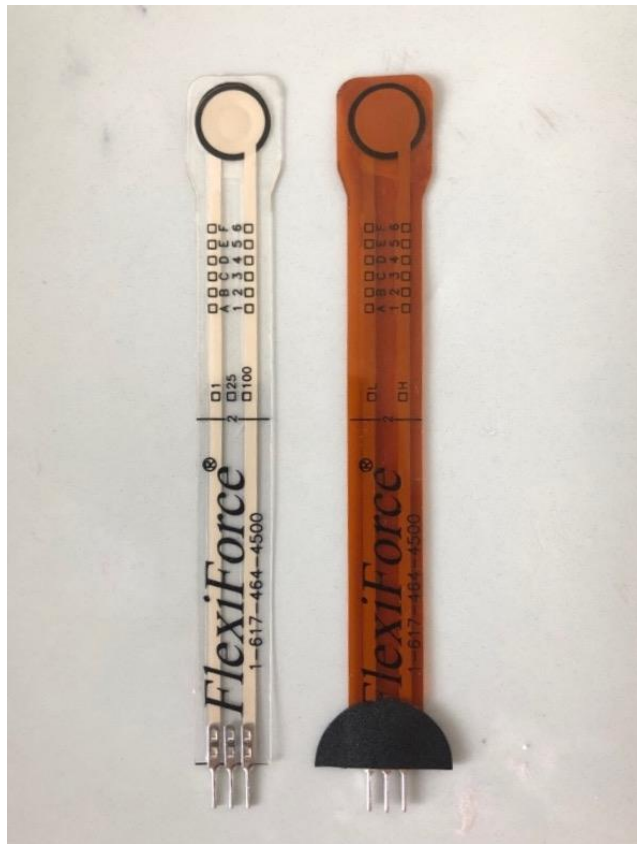
Abbildung 19: Transparenter FlexiForce-Sensor im Originalzustand sowie orangefarbener FlexiForce-Sensor mit individuell angebrachter Kunststoff-Schutzkappe zur speicheldichten Abschirmung des Konnektors (eigene Abbildung).
