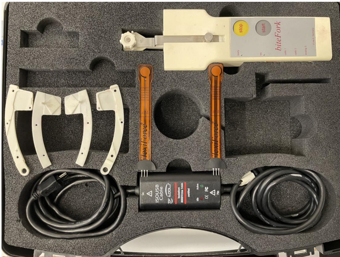
Abbildung 18: BiteFork® mit Sensor-Haltearmen, Datenübertragungskabel mit integriertem Netzteil und FlexiForce-Sensoren® (eigene Abbildung).
