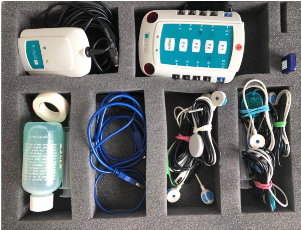
Abbildung 28: Zebris-EMG-Grundgerät, Netzteiladapter, USB-Datenübertragungskabel, aktive Differenzialelektrodenkabel sowie Reinigungszubehör (eigene Abbildung).
