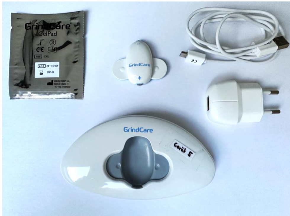
Abbildung 2: BUTLER GrindCare® 4 mit Basisstation sowie Netzteil, Netzkabel und Befestigungs-Gelpad zur adhäsiven Anbringung auf der Gesichtshaut (eigene Abbildung).
