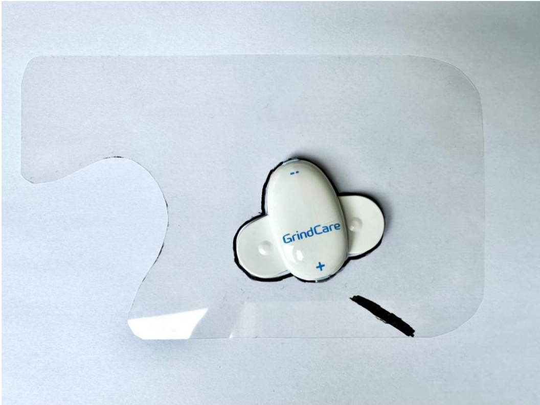
Abbildung 3: GrindCare® 4-Gerät mit individuell angefertigter Kunststoffschablone zur exakt reproduzierbaren Positionierung (eigene Abbildung).
