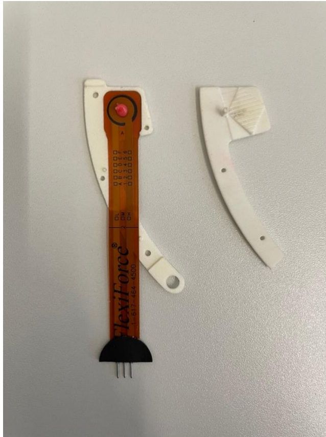
Abbildung 21: FlexiForce-Sensor™ in Basisplatte des BiteFork® -Haltearms mit aufgebrachtener Haftcreme und abgenommener Deckplatte (eigene Abbildung).
