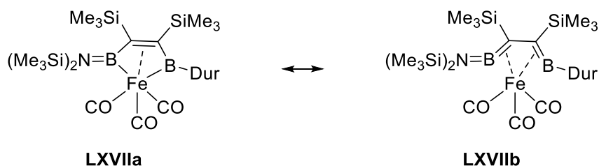
Abbildung 10: Grenzstrukturen von LXVII als Eisen- cis -Diboryl-Komplex ( LXVIIa ) bzw. Eisen-1,4-Diborabutadien-komplex ( LXVIIb ). [98]
