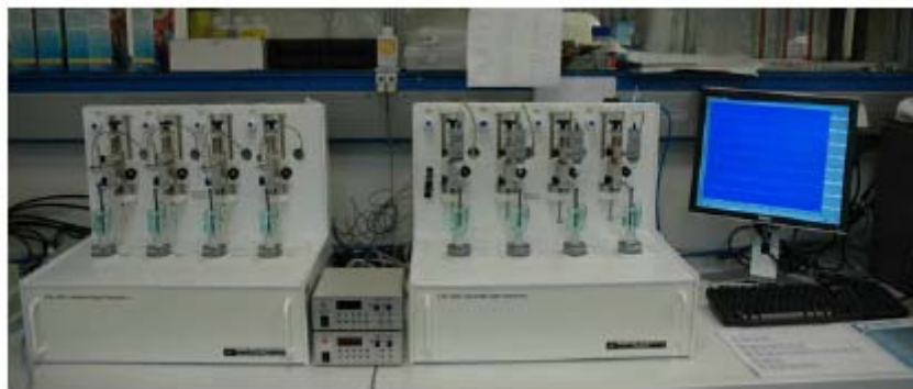
Abb.18: Darstellung eines Organbads: In den hier abgebildeten acht Kammern wird jeweils ein Aortenring untersucht. Auf dem Monitor sind in den nachfolgenden Versuchen die Gefäßreaktivität in Kurven dargestellt
