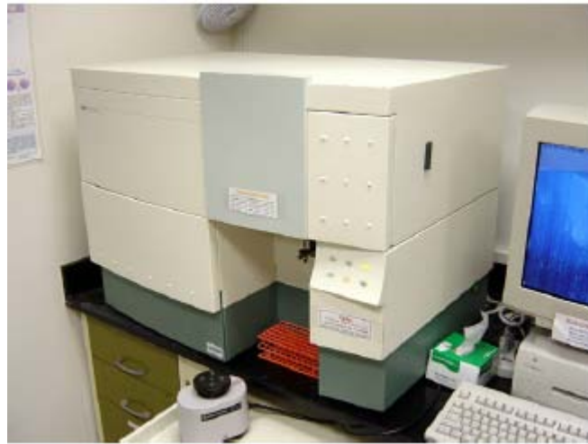
Abb.19: Darstellung eines FACS-Geräts: Mittels charakteristischem Verhalten im Vorwärts- und Seitwärtsstreuen wird die Thrombozytenpopulation erkannt
