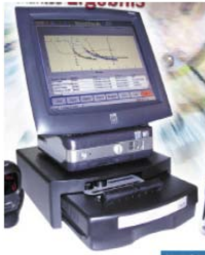
Abb.20: Darstellung eines Aggregometers: Dieses Modell PAP-8 mit acht Messkanälen der Firma Mölab wurde zur Thrombozytenaggregation-Messung eingesetzt
