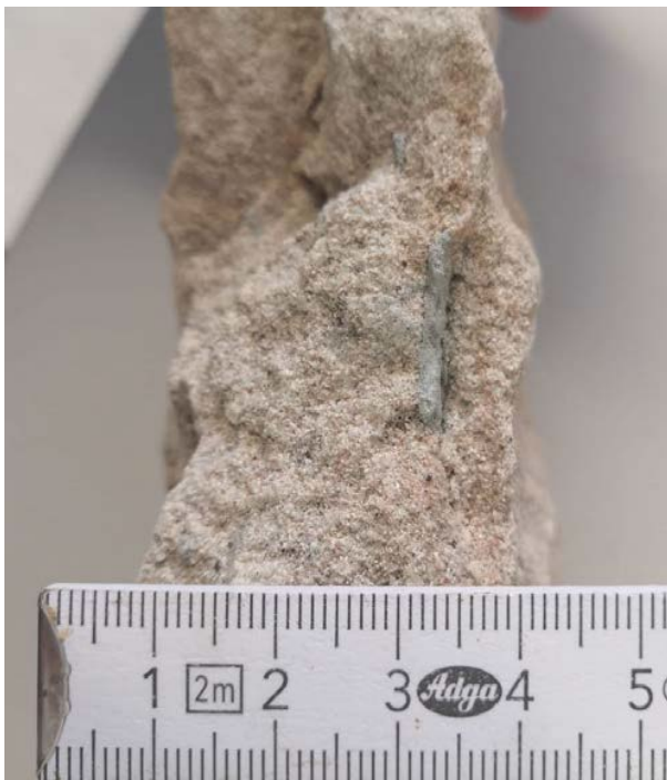
Abbildung 51: Blasensandstein mit charakteristischen zentimetergroßen grünweißlichen Toneinschlüssen. Handstück aus Profil VMK-II in ca. 35 cm Tiefe. Quelle: KAATSCH (2019).
