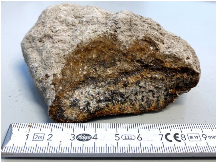
Abbildung 50: Blasensandstein mit schwarzen Mangantupfen. Handstück aus Profil CO 1. Im mittelkörnigen Sandstein sind die schwarzen Mangantupfen sehr deutlich erkennbar, Toneinschlüsse sind nicht erkennbar. Es könnte sich daher auch um einen Coburger Sandstein und nicht um einen Blasensandstein handeln. Quelle: eigene Aufnahme.
