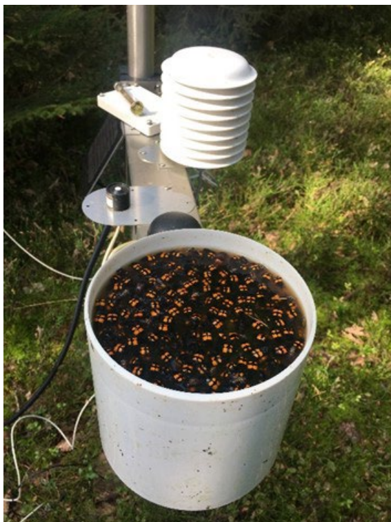
Abbildung 10: Verstopfter Niederschlagssensor der Monitoringstation Willmars.
