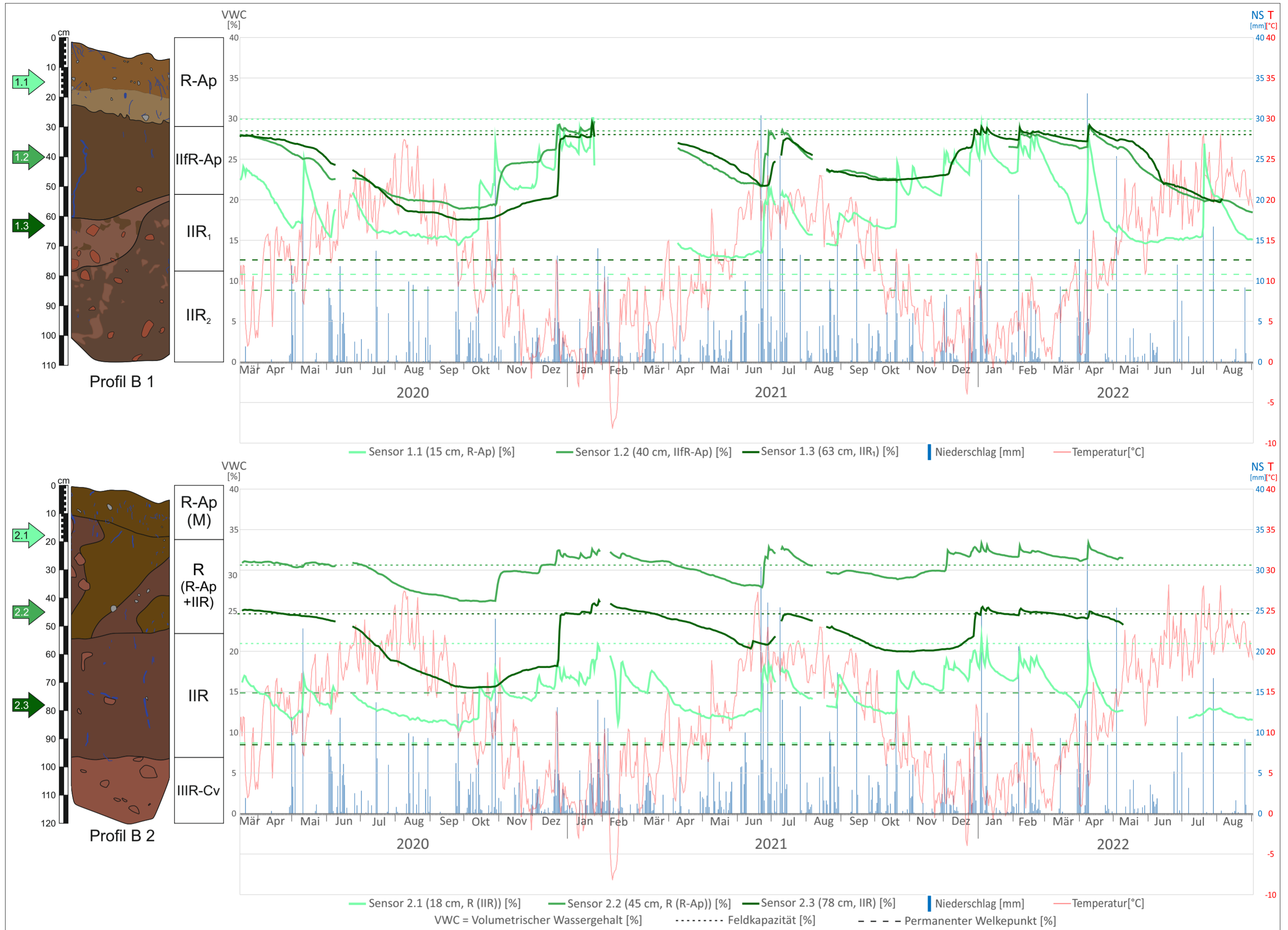
Abbildung 69: Monitoringzeitreihen der Profile B 1 und B 2 (Rigosole; Mittelhang) für den Beobachtungszeitraum 16.03.2020 bis 02.09.2022
