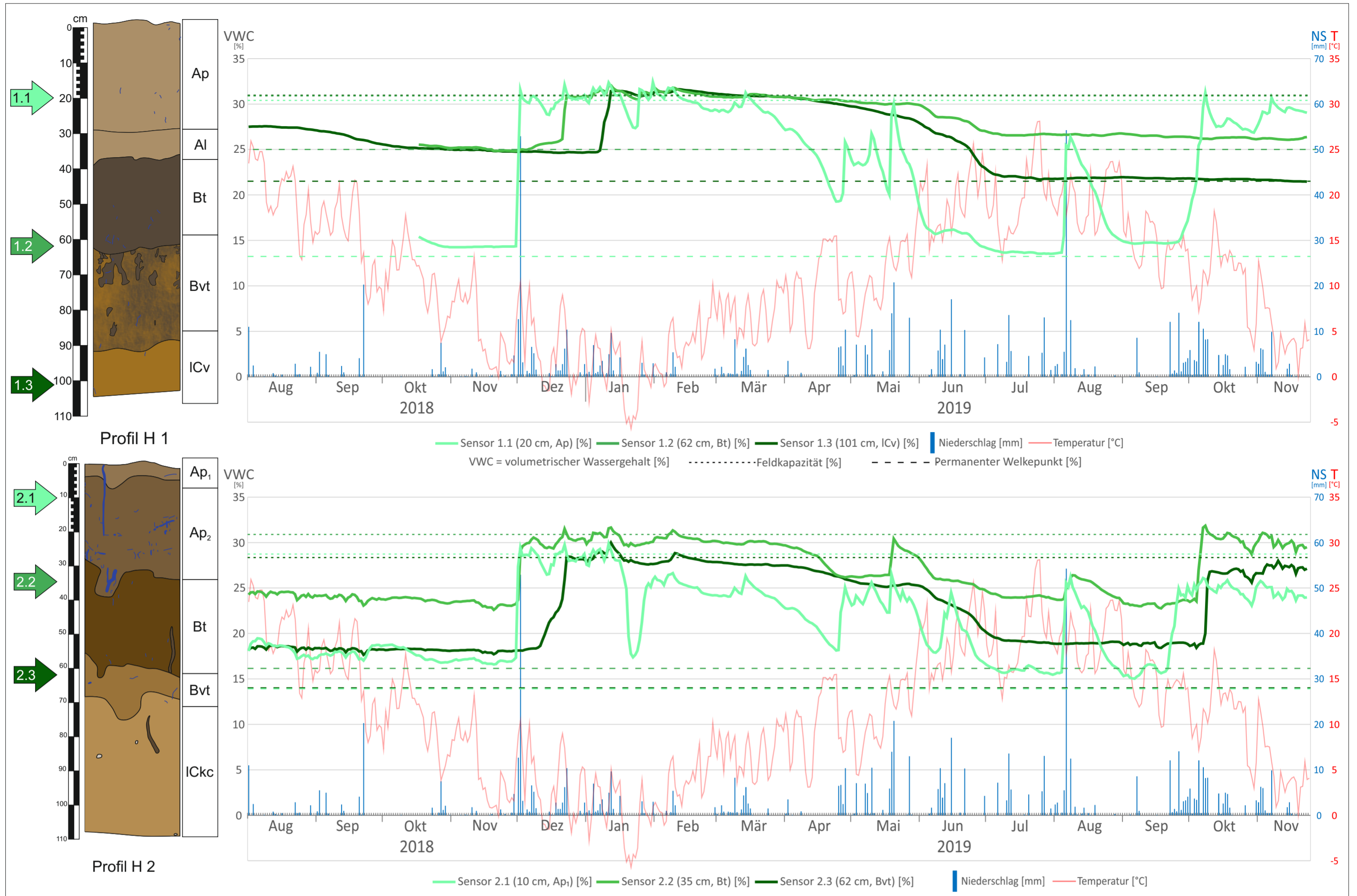
Abbildung 70: Monitoringzeitreihen der Profile H 1 und H 2 (Parabraunerden; Ebene) für den Beobachtungszeitraum 02.08.2018 bis 25.11.2019
