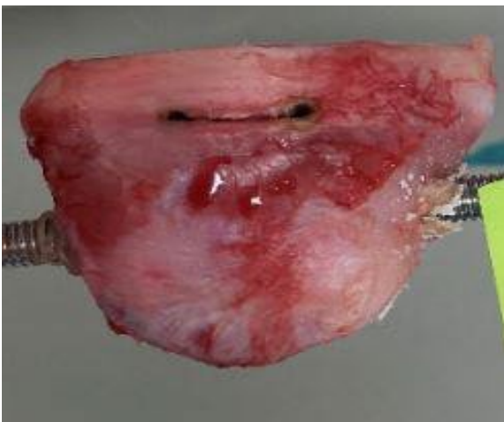
Abbildung 23: Versagensmechanismen, links Cutting through (CT) mit Defekt der Kortikalis, rechts isolierter Bandriss (BR) eines 3 mm Nylon Tapes mit intakter Kortikalis
