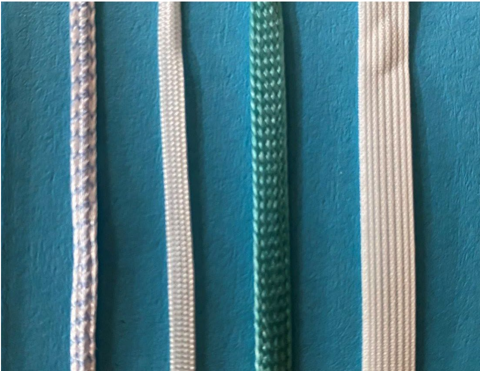
Abbildung 6: Verwendetes künstliches Bandmaterial, von links nach rechts: 2 mm Fiber Tape, 3 mm Nylon Tape, 4 mm geflochtenes Tape, 5 mm Mersilene Tape
