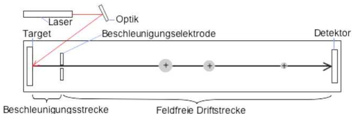
Abbildung 6: Aufbau eines ToF Massenspektrometers
