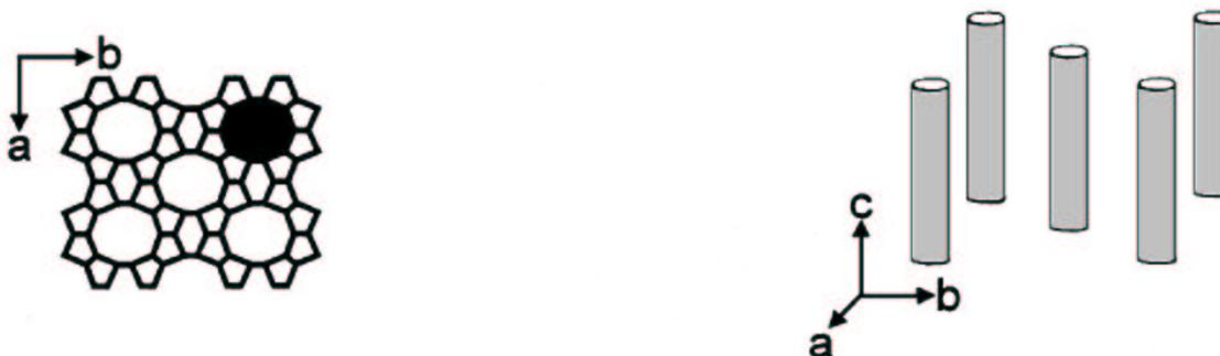
**Abb. 4.21 :** TON-Porosile (Silica-ZSM-22) enthalten ein eindimensionales Kanalsystem, in dem die  $\text{I}_2$ -Gastkomponenten eingelagert sind. Die Kanäle haben nur einen Durchmesser von etwa  $5 \text{ \AA}$ , so dass die Achsen der  $\text{I}_2$ -Moleküle entlang des Kanals orientiert sind.
