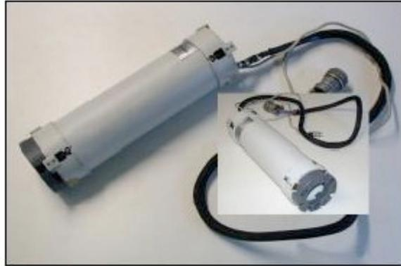
**Abb. 6:** BRUKER Mikroskopie Gradientensystem G60
