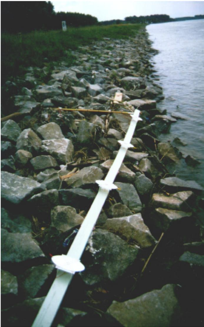
Abbildung 5.25 Messanordnung mit vier  $160 \text{ cm}^2$  großen ellipsenförmigen Edelstahlelektroden (Wenner-Anordnung).
