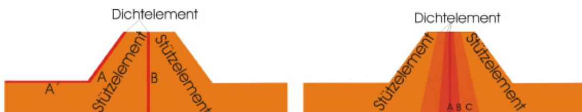
Abbildung 2.3: Hydraulische Barrieren. Wasserseitige Oberflächendichtung (links A). Dichtungsteppich (links A'). Zentrale Dichtung (links B). Kerndichtungen (rechts) mit zunehmender Durchlässigkeit von A nach C.
