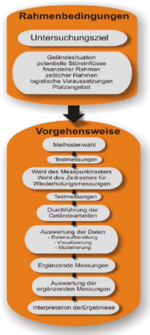
Abb. 5.1: Die Vorgehensweise bei der Durchführung einer zerstörungsfreien Erkundung
