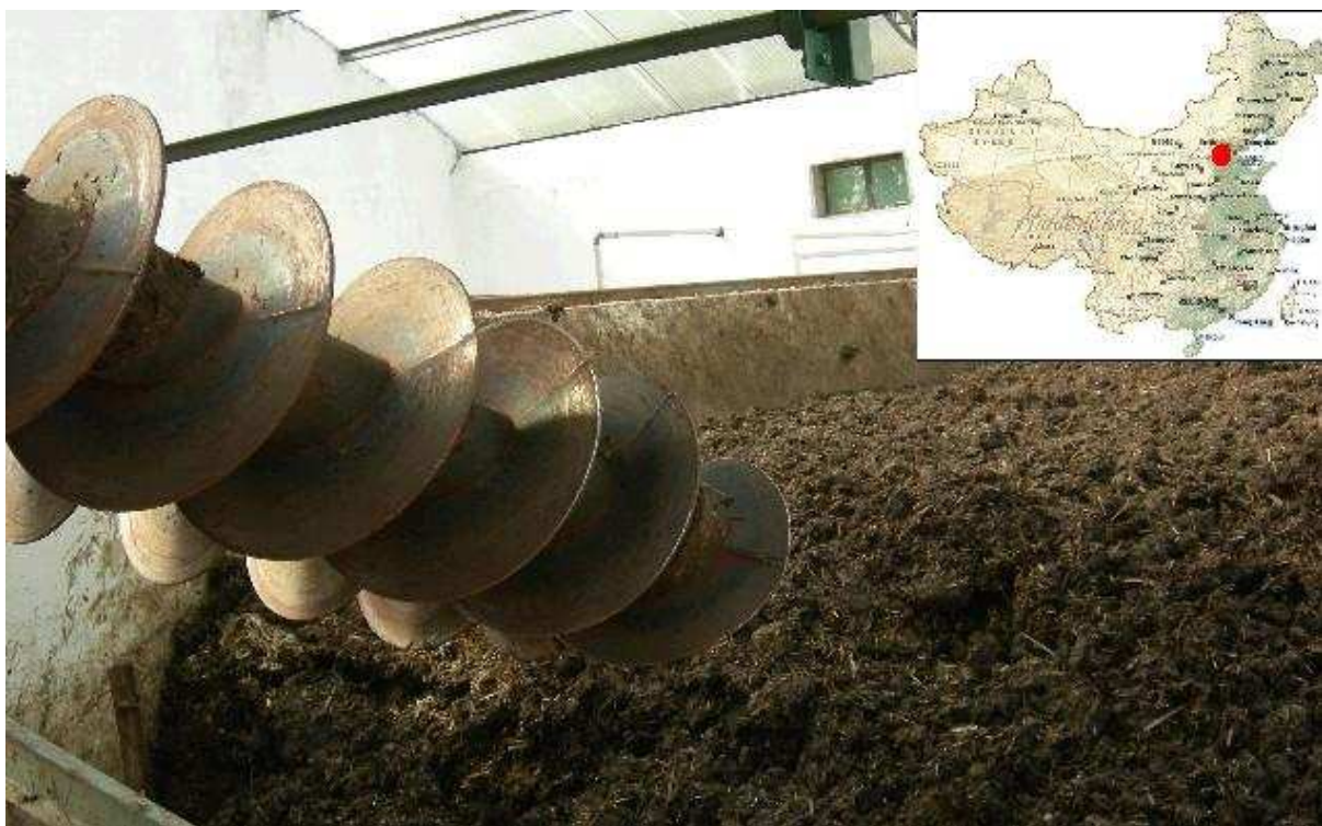
Abbildung 5-27 : Trockenfermentation mit liegendem Fermenter und Rührwerk des China-Beispielprojekt 3 mit Übersichtskarte Chinas (roter Punkt: die betroffene Region) (Foto von Chenxing Wang)
