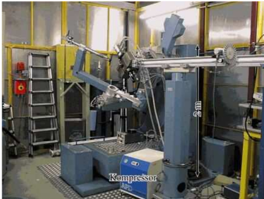
Abbildung 11: Foto des Sechskreis-Diffraktometers an der Beamline BW2 am HASYLAB (aus [16]).
