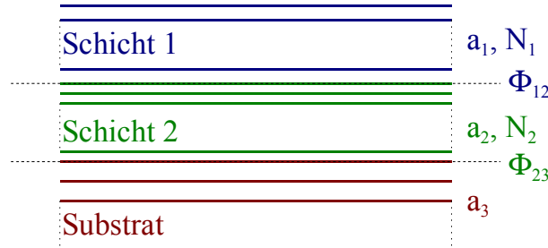
Abbildung 8: Schematische Darstellung einer Doppellage auf einem Substrat mit N_{1,2} Netzebenen und dem Netzebenenabstand a_{1,2} der beiden Schichten. a_3 gibt den Netzebenenabstand des halbunendlichen Substrates an. Eine an den Grenzflächen mögliche Phasenverschiebung wird durch \Phi_{12,23} angegeben.
