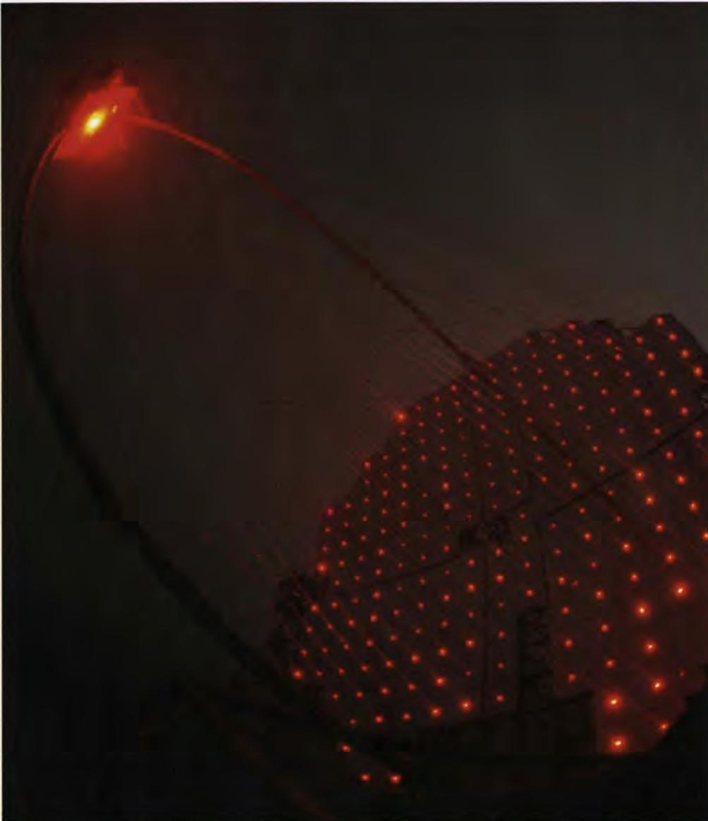
*Mit einem Laser-Kalibrations-system werden die Segmente des Teleskopspiegels nachjustiert. Dadurch bleibt eine hohe Abbildungsqualität auch nach schnellen Dreh- und Schwenkbewegungen gewährleistet.*
