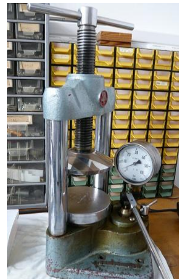
Abbildung 16: Hydraulikpresse, in der die Messkörper ihre Form erhielten
