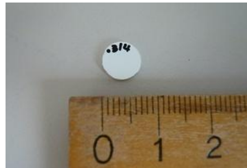
Abbildung 18: fertiger Messkörper aus Hydroxylapatit
