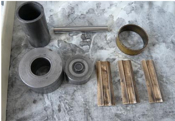
Abbildung 15: Metallformen für Messkörperherstellung
