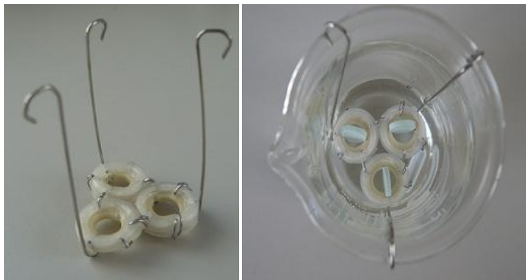
Abbildung 25: Haltevorrichtung für Messkörper
