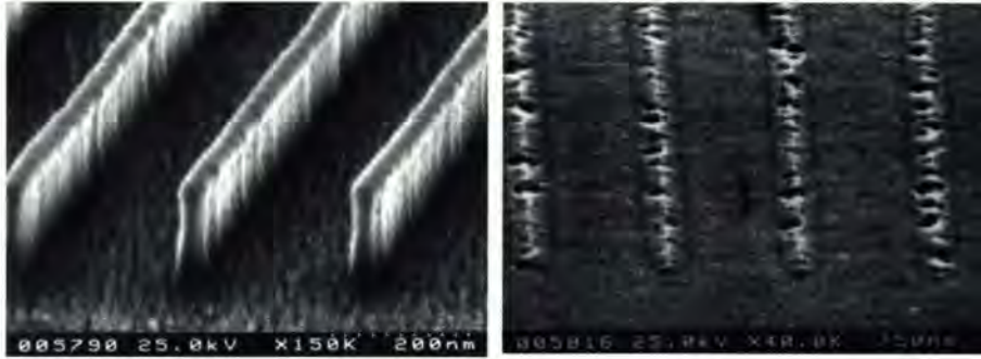
Abb. 3: Elektronenmikroskopische Aufnahmen geätzter (links) und überwachsener (rechts) Quantendrähte. Der Maßstab ist jeweils unten rechts eingetragen.
