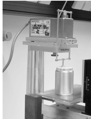
Abb. 4-12: Zugspannungstester in Ausgangsposition mit vorbereiteter Probe
