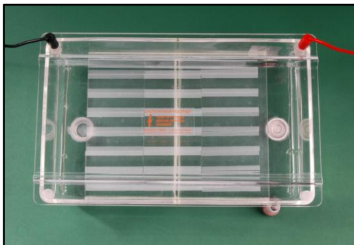
Abbildung 2.6: Aufsicht auf eine mit 21 seitlich mattierten Objektträgern bestückte Elektrophoresekammer mit Deckel. Länge, Breite und Höhe der Kammer sind 34 cm × 21 cm × 7 cm.
