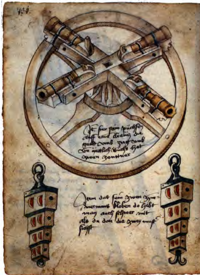
Abb. 4: Johannes Formschneider, Büchsenmeisterbuch, Nürnberg um 1460. Drehbares Vierfachgeschütz zum Einsatz auf Rundtürmen; jedes Rohr ist einzeln in seiner Lade höhenverstellbar. Unten Einzelteile von mehrstufigen Flaschenzügen zum Transport der
