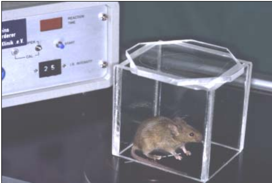
Abb. 3. Hitzestimulationsgerät mit einer Maus im Plexiglaswürfel auf einer Glasplatte. Die mobile Wärmequelle ist unter der rechten Hinterpfote plaziert.
