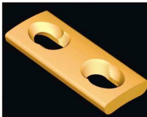
Abb 3: "Locking compression Plate®". Durch das vorgeschchnittene Gewinde im Plattenloch kann die winkelstabile Schraube nur in der vorgegebenen Richtung eingebracht werden (Frigg 2003).
