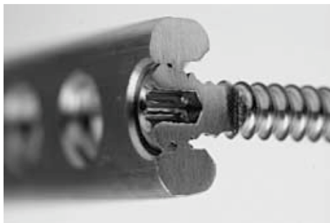
Abb 4: TiFix® (Fa. Litos, Hamburg). Winkelstabile Verbindung durch Kaltverschweißung einer weicheren Titanlegierung der Platte und einer härteren Titanlegierung des Schraubenkopfes. (Wolter et al. 2001)
