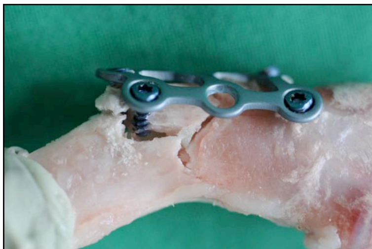
Abb 24: Versagensmechanismus Typ 1: Versagen der Osteosynthese durch Ausbruch der Schrauben aus dem Knochen.
