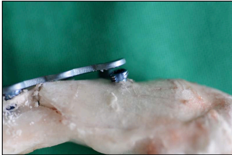
Abb 25: Versagensmechanismus Typ 2: Versagen durch Verlust der winkelstabilen Verblockung
