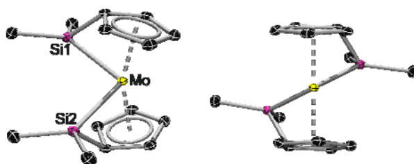
Abbildung 44. Molekülstruktur von 16 . Wasserstoffatome sind nicht dargestellt. Die thermischen Ellipsoide repräsentieren 50% Wahrscheinlichkeit. Ausgewählte Bindungslängen [pm] und -winkel [°]: Mo–Si1 249.15(4), Mo–Si2 248.66(4), Si1–C ipso 185.28(14), Si2–C ipso 185.70(14), Mo–X cent1 194.2(1), Mo–X cent2 194.1(1), Si1–Mo–Si2 94.90(1), C ipso –Si1–Mo 61.15(4), C ipso –Si2–Mo 61.13(4), \delta 154.38, \beta_{\text{Si1}} 48.7, \beta_{\text{Si2}} 48.9, \alpha 20.48(7).
