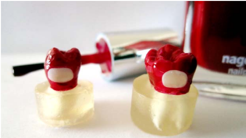
Abbildung 12. Abdichten der Präparate durch Nagellack-Applikation.
