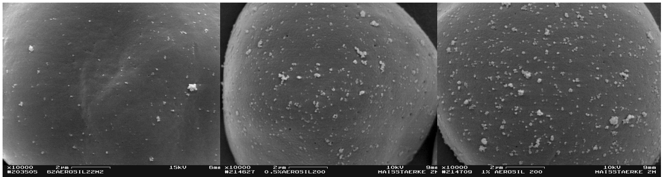
Abb. 5.129: Aerosil 200 ® -Agglomerate auf Maisstärke (0,2% Aerosil 200 ® )
