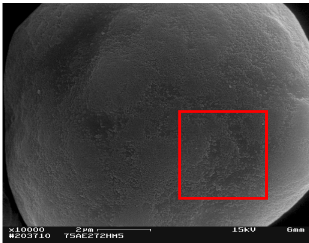
Abb. 5.106: Kugelförmiges Maisstärkekorn (x10.000), 0,2% Aerosil 200 ® in Maisstärke: 72h Mischzeit
