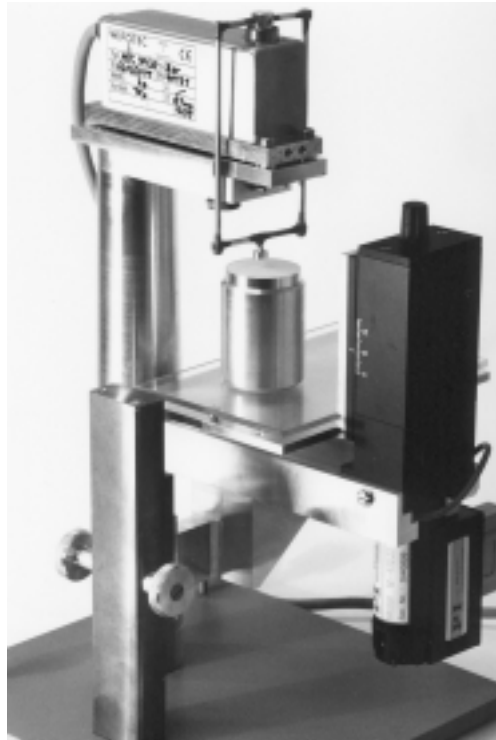
Abb. 4.5: Zugspannungstester nach Schweiger [25] mit Modifikation des Messkörpers nach Anstett [56]
