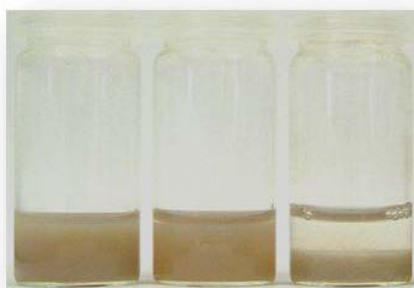
Abbildung 59: Dispergierungsversuch der arylierten Detonationsnanodiamanten 35-MS (links), von 35-BLS (mittel) und 35-BASD (rechts).
