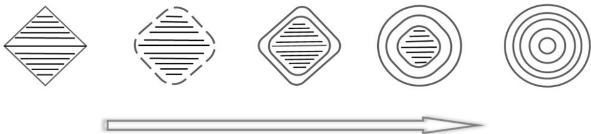
Abbildung 7: Schematische Darstellung der Umwandlung einer Nanodiamant in eine Nanozwiebel.
