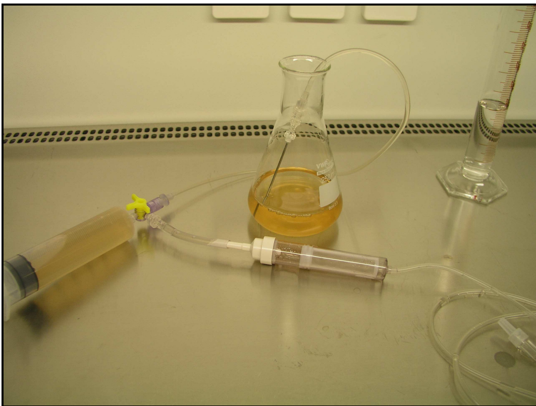
Abb. 8: Filtration der Enzym-/Gewebelösung durch ein handelsübliches Blut-Transfusionset.
